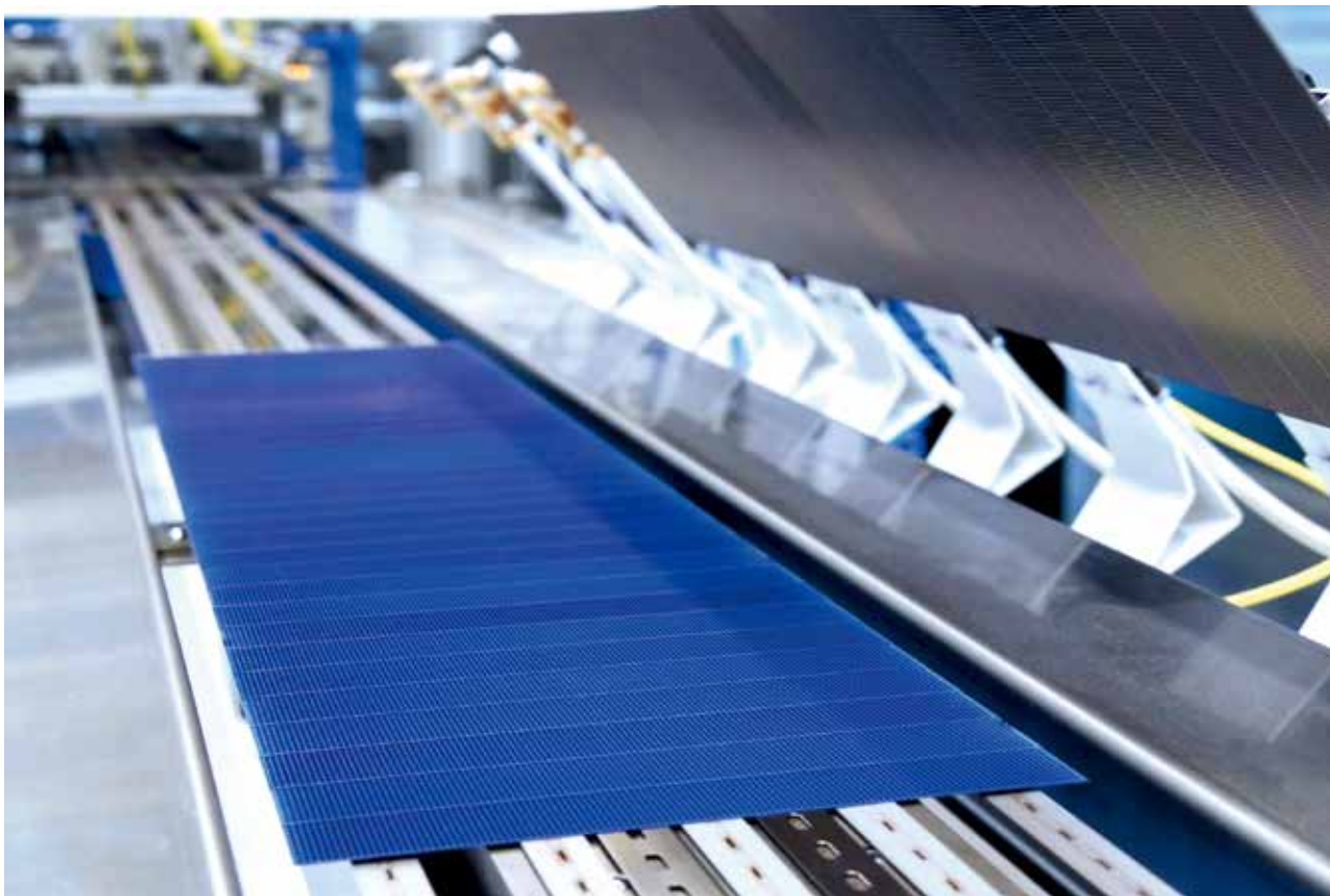
图十二：由 TT1800 串焊机制造的叠瓦太阳能电池串，接下来可进行组件封装。
