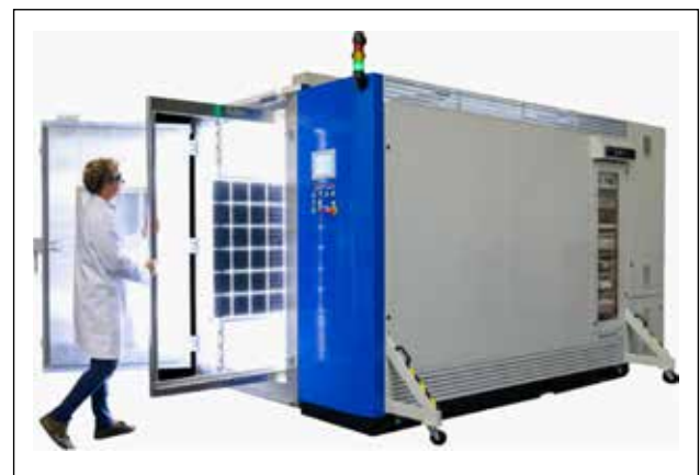
图十：气候室太阳模拟器 (CCSS)，能够对不同光伏技术组件进行加速温度、辐照度和湿度测试。
