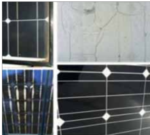
图三：代表性外观失效(依次从左上角开始顺时针方向)：玻璃腐蚀、背板开裂、蜗牛纹、封装材料变色。
