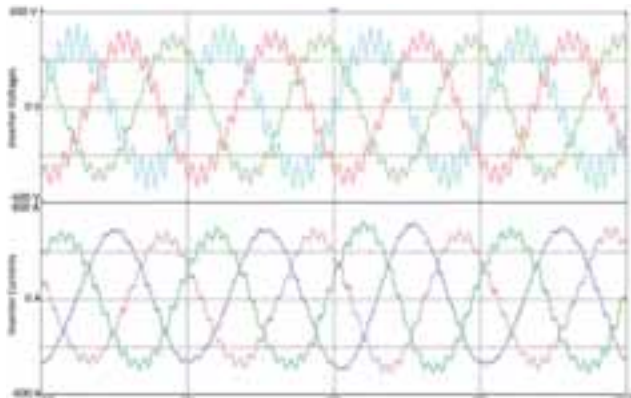
图二：850Hz时谐波振荡；逆变器电压(上)和电流(下)的瞬时值
