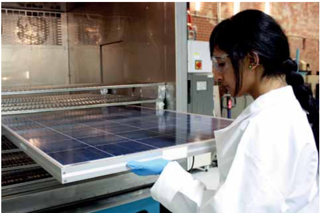
图四：Fraunhofer CSE研究员在环境模拟舱内设置组件以进行PID测试。© Fraunhofer CSE
