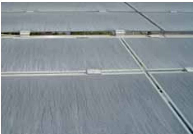
图三：实验场地内受污染组件局部放大图
