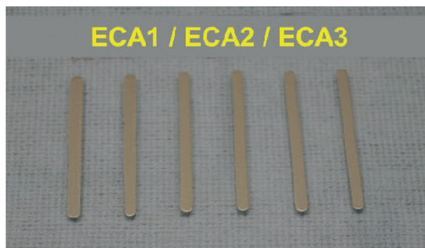
图二:在玻璃基板上印刷的ECA线,并用封装材料层压,用玻璃覆盖。
