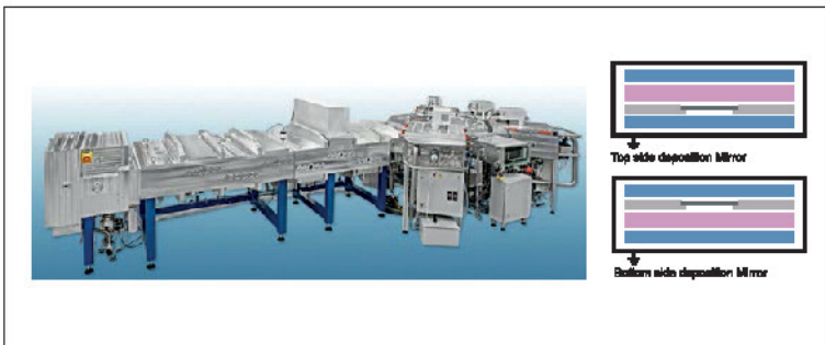
图六：INDEPtec 研制的 OCTOPUS II，采用了镜像反应器概念。硅片每次只放置在一个载盒上，并在同一个载盒上完成前表面和背面 a-Si:H 镀膜操作。
