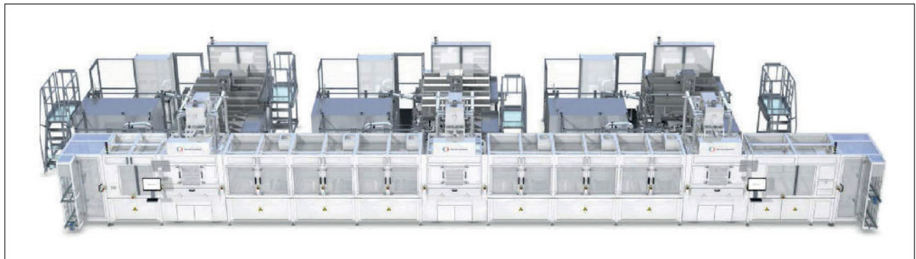
图五：梅耶博格的 HELiA PECVD 设备，使用了基于“等离子盒子”概念的反应器，能够保证制备出完美均匀统一的材料层，并降低污染并促进反应器清洁 [35]。硅片载盒每次只接触一个沉积腔体，避免了污染物从载盒中引入。
