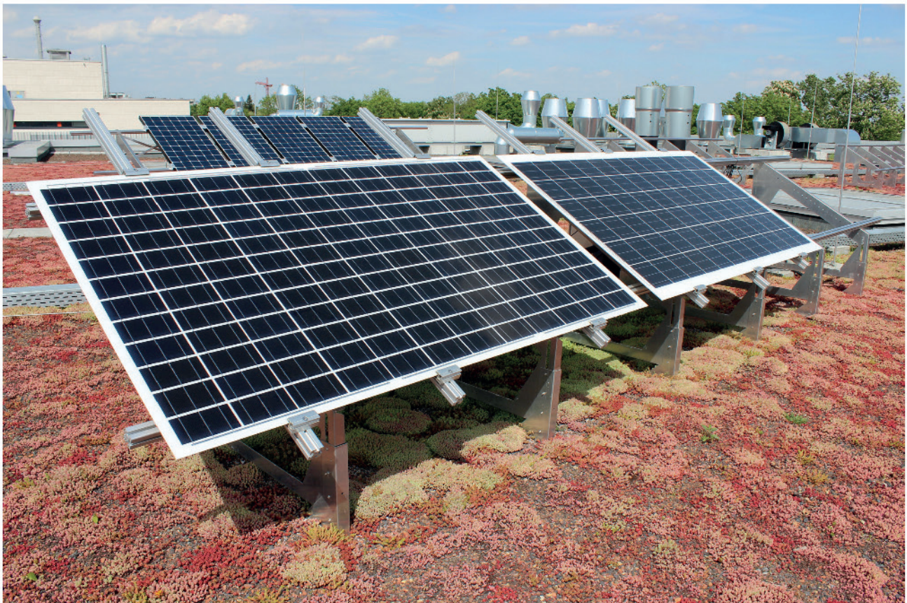
图九：安装在弗劳恩霍夫 CSP “Halle 户外光伏实验室” 的半切片电池组件（左）全尺寸组件（右）。
